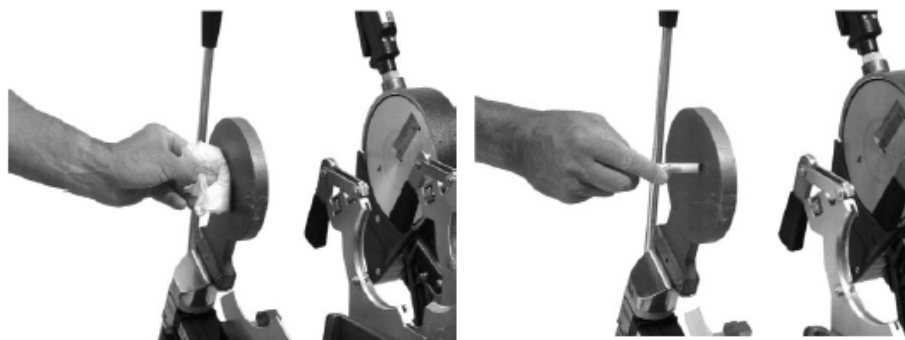
Obr. 1 – Čistění svařovacího zrcadla. Dbejte, aby nedošlo k poškození teflonové vrstvy
